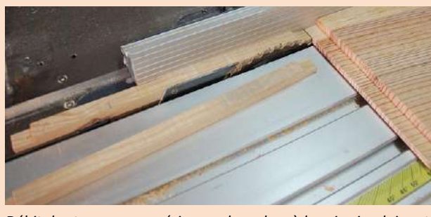
Débit des traverses supérieures de cadres à la scie circulaire et au guide parallèle.
