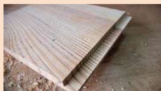
L'usinage de cette feuillure d'assemblage est vraiment impeccable... le montage n'en sera que plus facile.
